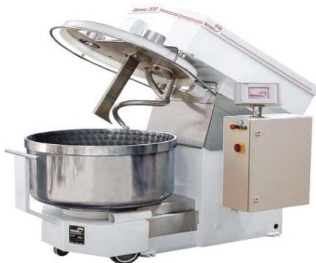
Рис. 7.4 - Зовнішній вигляд тістомісильної машини «ПРИМА– 300»
