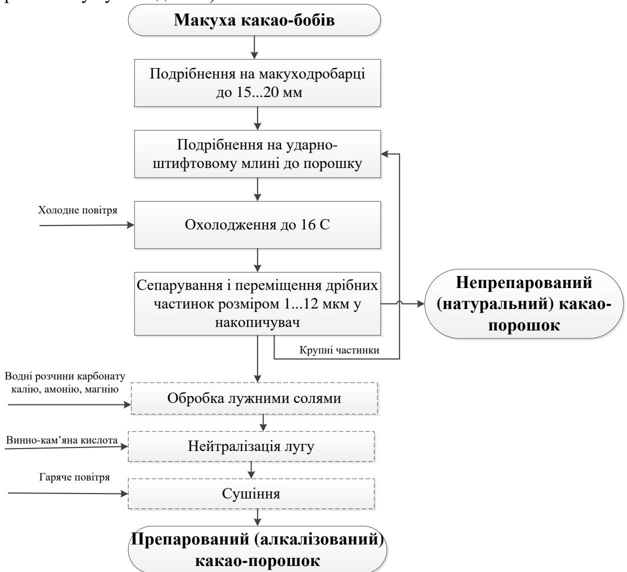
Рис. 8.3. Принципово-технологічна схема виробництва какао-порошку
