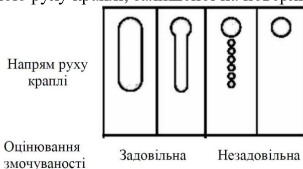
Рис. 1.1. Форма краплі для оцінювання змочуваності фольги
