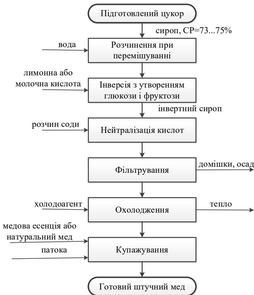
Рис. 15.9. Принципово-технологічна схема отримання штучного меду
