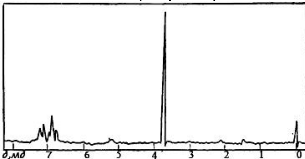
Рис. 220. Спектр ^1H ЯМР сполуки складу C_7H_8O .
