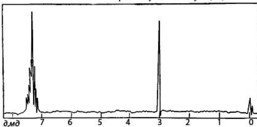
Рис. 187. Спектр ^1H ЯМР сполуки складу C_8H_6 .
