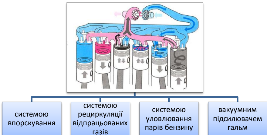
Рис. 2.30. Взаємодія системи впуску з системами
