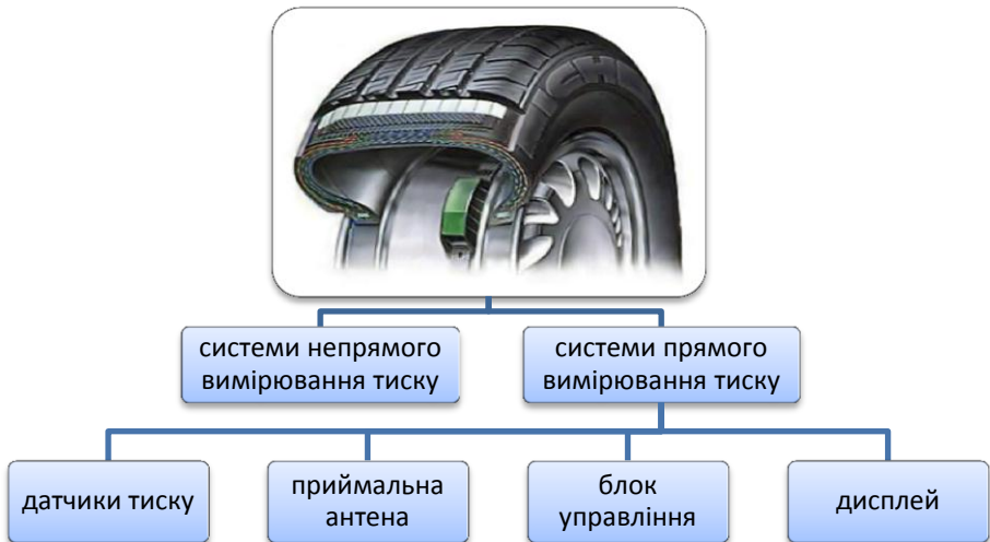
Рис. 4.8. Види систем контролю тиску в шинах
