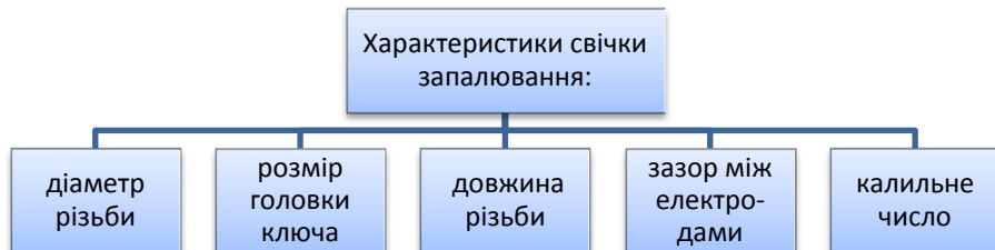
Рис. 2.53. Характеристики свічки запалювання
