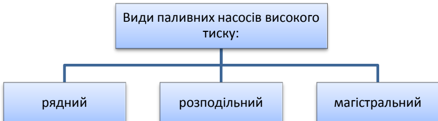
Рис. 2.27. Види паливних насосів високого тиску
