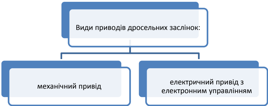
Рис. 2.32. Види приводів дросельних заслінок
