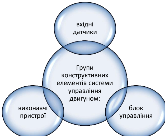
Рис. 2.34. Групи конструктивних елементів системи управління двигуном
