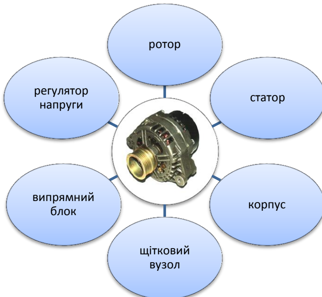
Рис. 4.2. Будова автомобільного генератора
