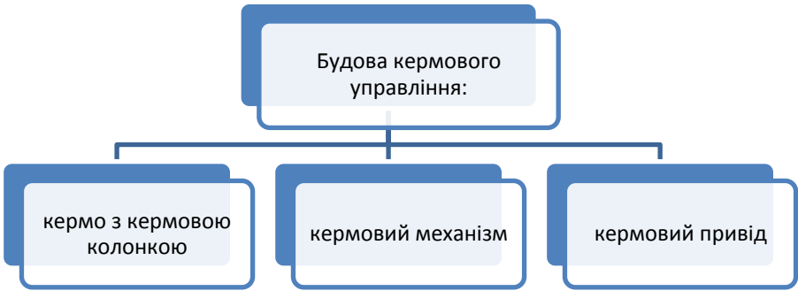
Рис. 3.43. Будова кермового управління
