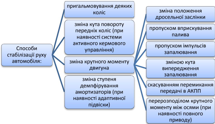
Рис. 5.6. Способи стабілізації руху автомобіля
