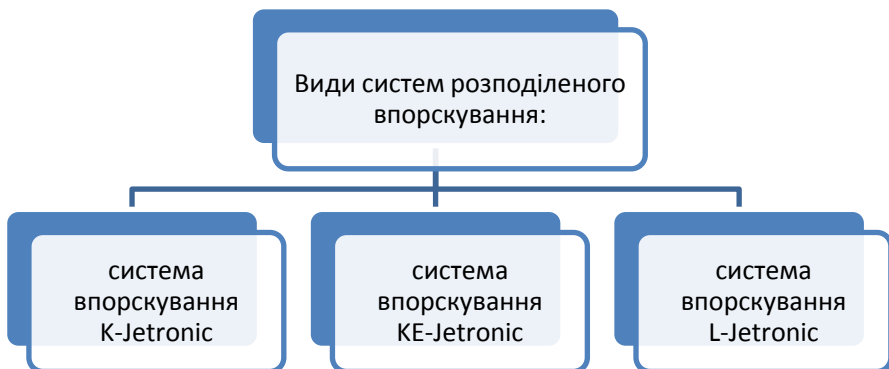
Рис. 2.19. Види систем розподіленого впорскування
