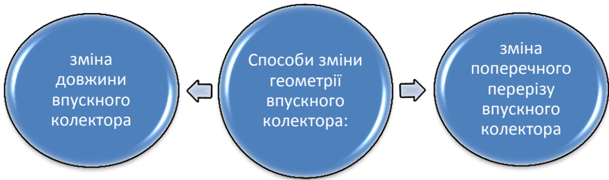
Рис. 2.40. Способи зміни геометрії впускного колектора
