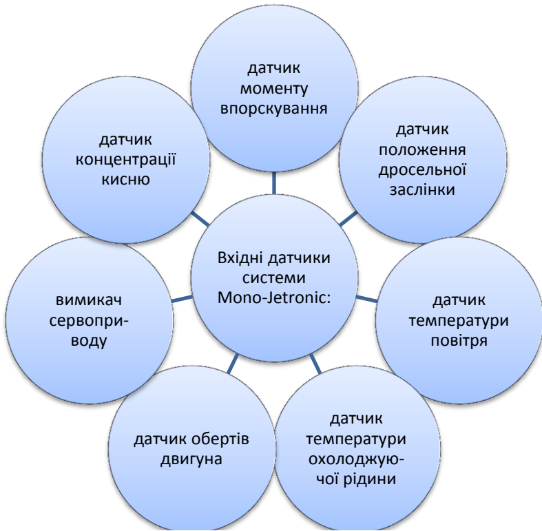
Рис. 2.18. Вхідні датчики системи Mono-Jetronic
