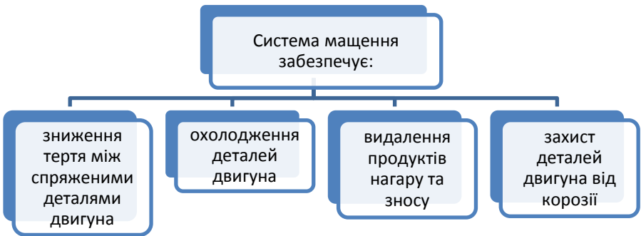
Рис. 2.66. Призначення системи мащення
