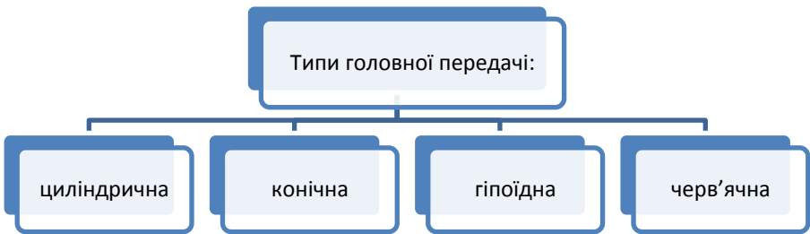
Рис. 3.26. Типи головної передачі
