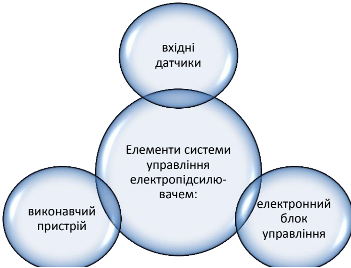
Рис. 3.50. Елементи системи управління електропідсилювачем
