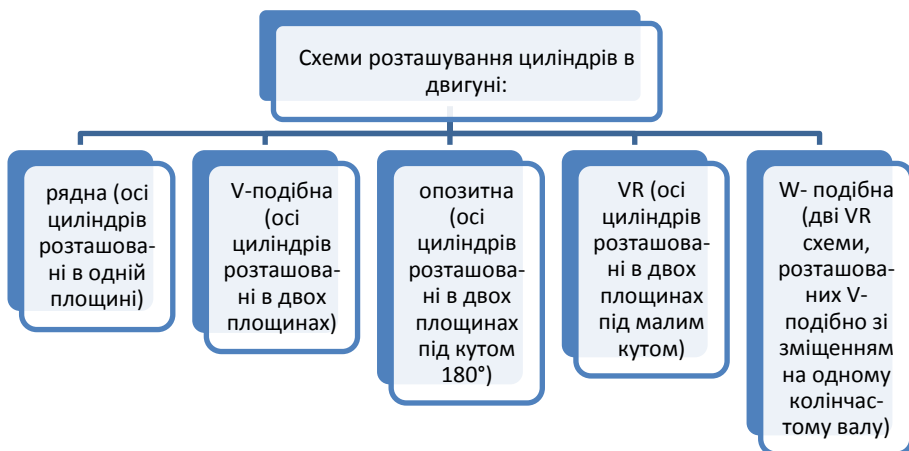
Рис. 2.6. Схеми розташування циліндрів в двигуні
