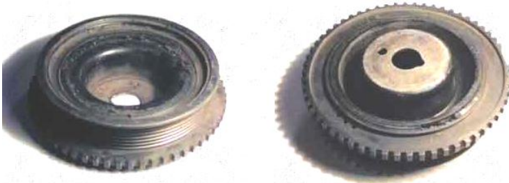
Рис. 5.5. Шків привода генератора з пошкодженим демпфером
