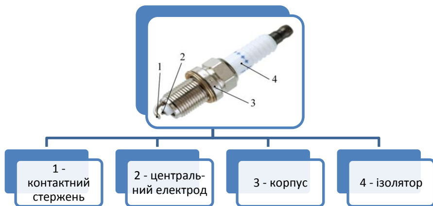
Рис. 2.51. Будова свічки запалювання
