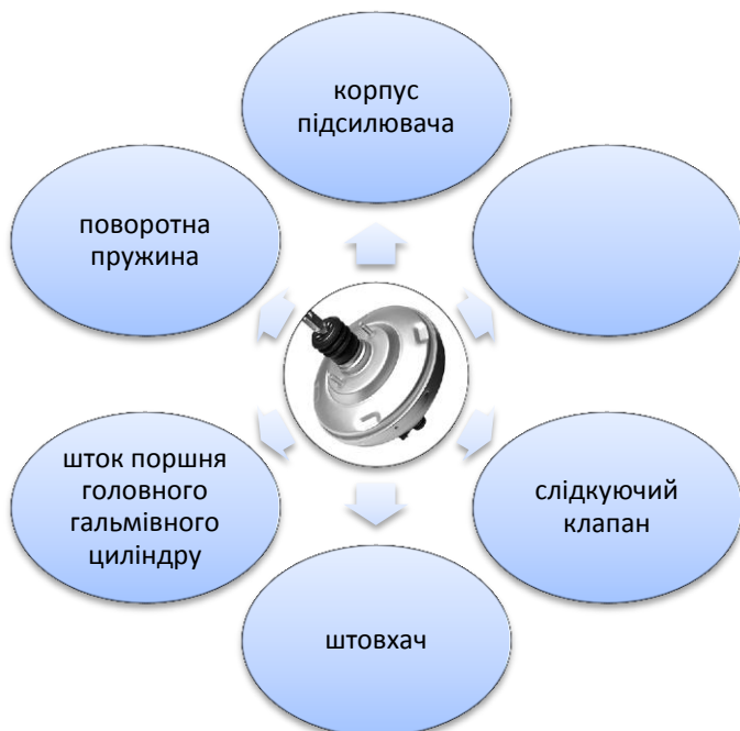
Рис. 3.5. Будова вакуумного підсилювача гальм
