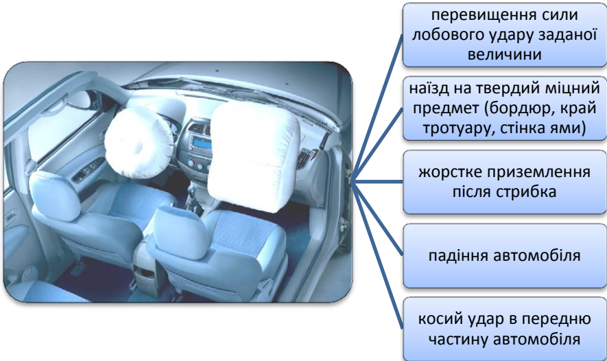
Рис. 5.18. Умови спрацювання фронтальних подушок безпеки
