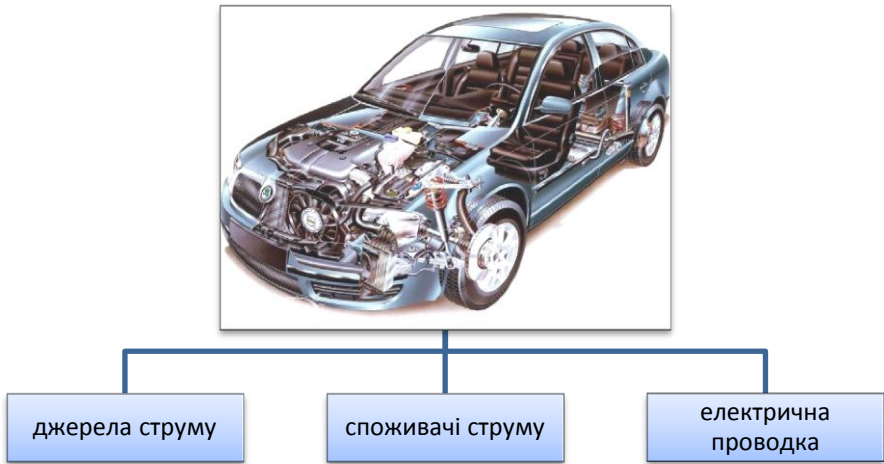
Рис. 4.1. Будова автомобільного електрообладнання
