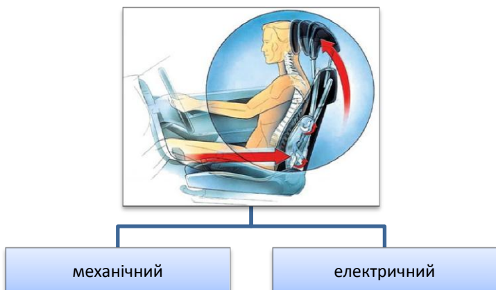
Рис. 5.19. Види приводу активного підголівника
