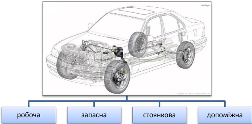
Рис. 3.4. Різновиди гальмівних систем за призначенням
