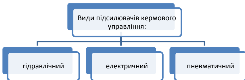
Рис. 3.46. Види підсилювачів кермового управління
