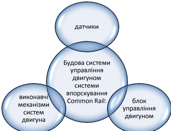
Рис. 2.28. Будова системи управління двигуном системи впорскування Common Rail
