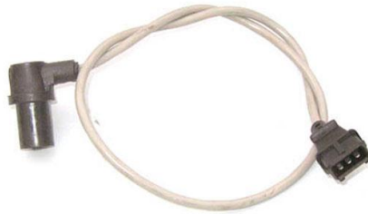
Рис.5.1. Датчик положення колінчастого валу
