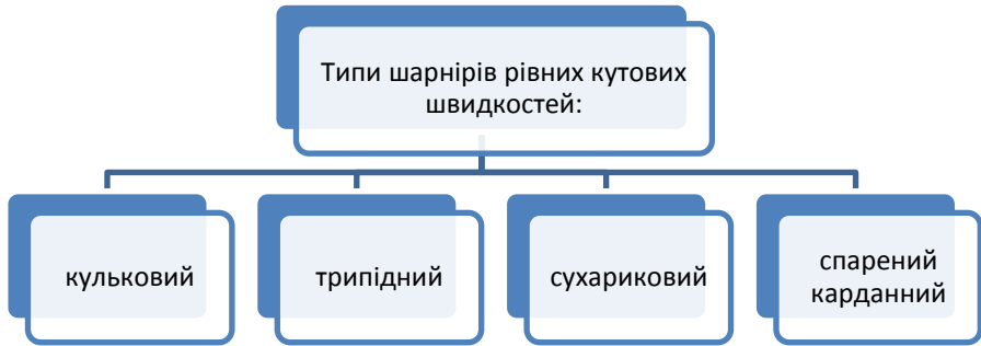
Рис. 3.24. Типи шарнірів рівних кутових швидкостей
