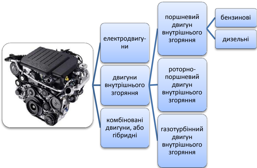
Рис. 2.1. Види автомобільних двигунів залежно від виду перетворюваної енергії
