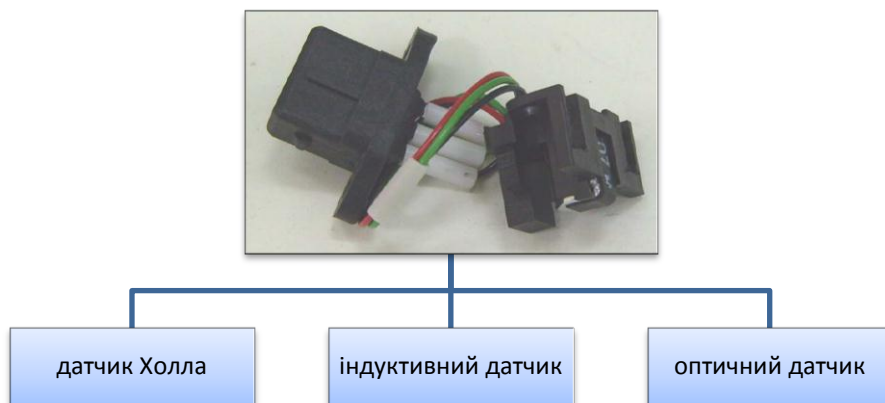
Рис. 2.55. Види датчиків імпульсів
