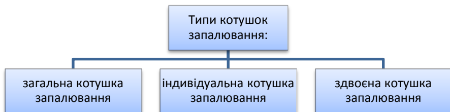
Рис. 2.50. Типи котушок запалювання
