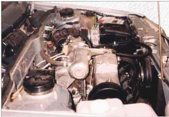
Рис. 9.3. Розташування датчика масової витрати повітря
