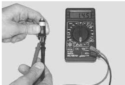
Рис. 2.2. Вимірювання опору електромагнітної форсунки
