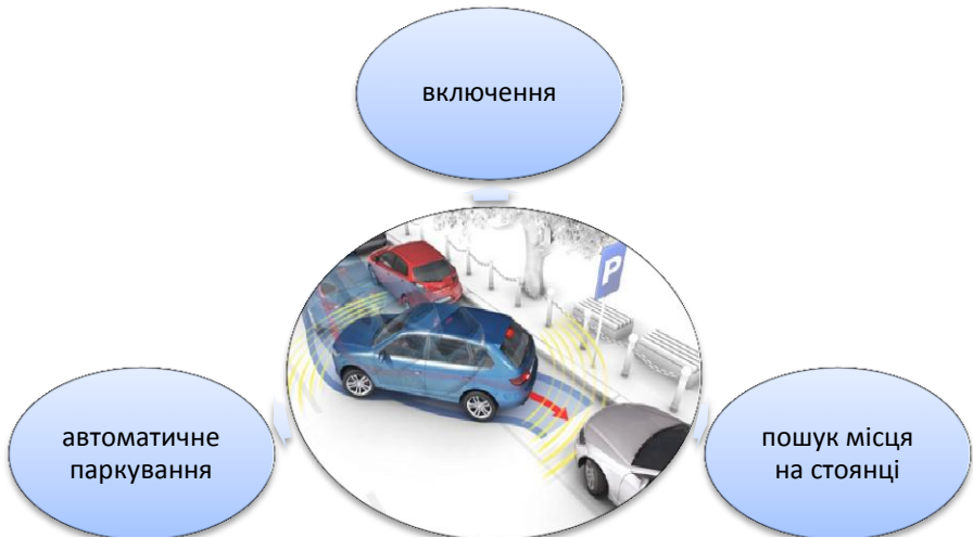
Рис. 5.10. Режими роботи паркувального пілота
