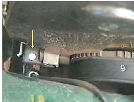
Рис. 5.2. Місце установки датчика положення колінчастого валу
