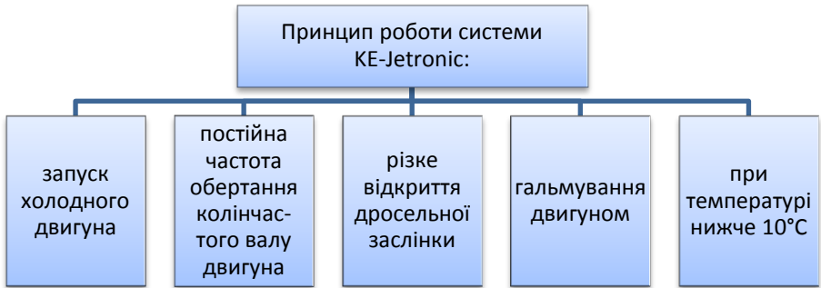
Рис. 2.22. Принцип роботи системи KE-Jetronic
