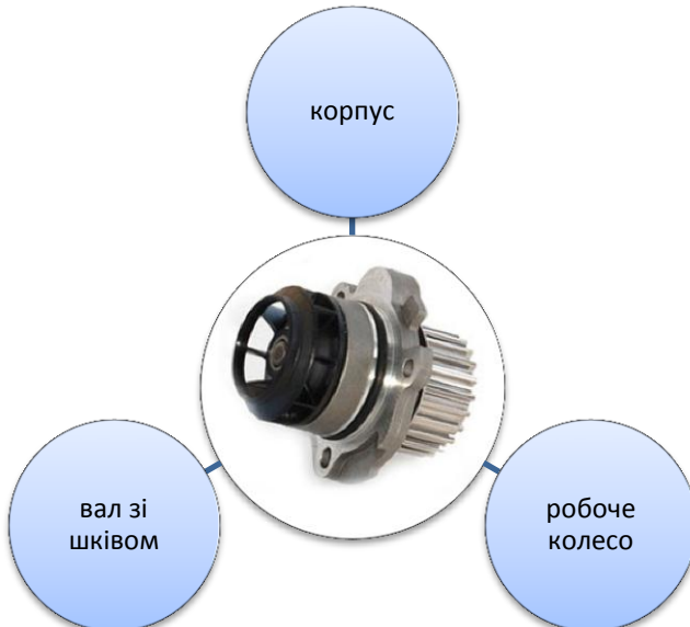
Рис. 2.63. Будова насоса охолоджуючої рідини
