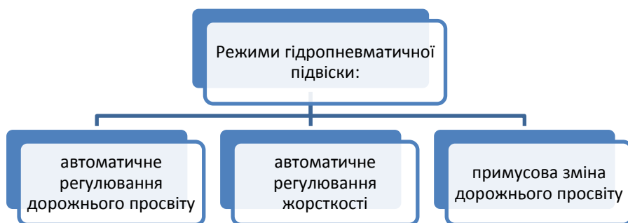
Рис. 3.42. Режими гідропневматичної підвіски
