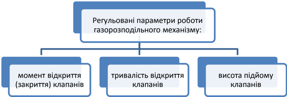
Рис. 2.36. Регульовані параметри роботи газорозподільного механізму
