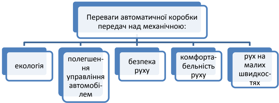
Рис. 3.19. Переваги автоматичної коробки передач
