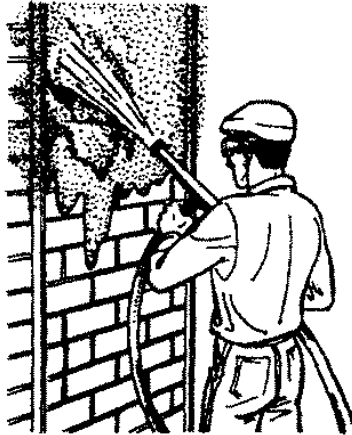
Мал. 2.15 Штукатурення пневматичною форсункою
