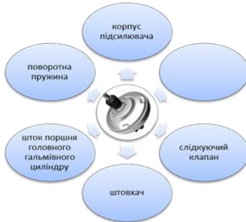
Рис. 1.50 Будова вакуумного підсилювача гальм
