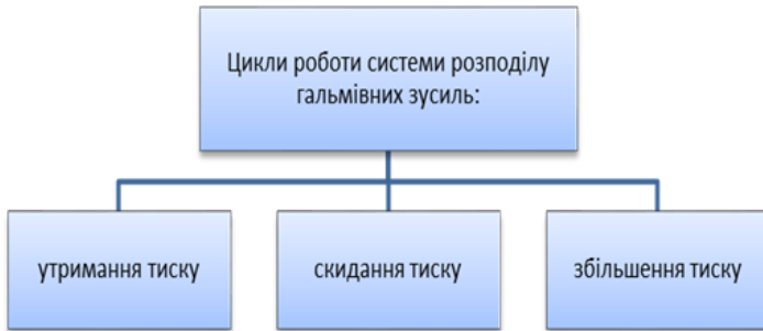
Мал. 1.56 Цикли роботи системи розподілу гальмівних зусиль
