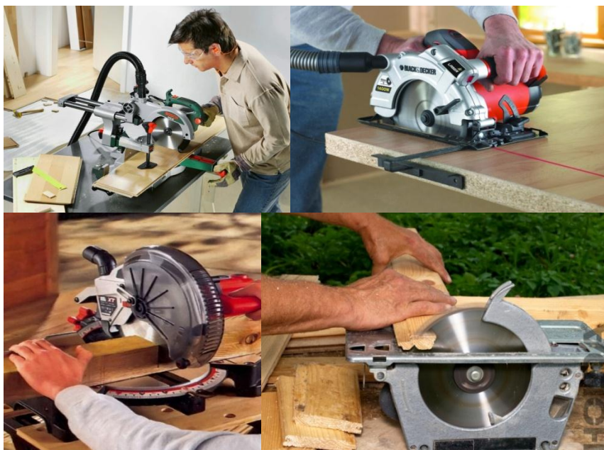
Мал. 2.20 Виконання роботи дисковими електропилками
