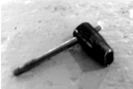
Рис. 7. Ключ для відкручування гайки-баранця
