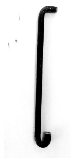
Рис. 6. Варіанти виконання скоб для стискання рамки лобзика
