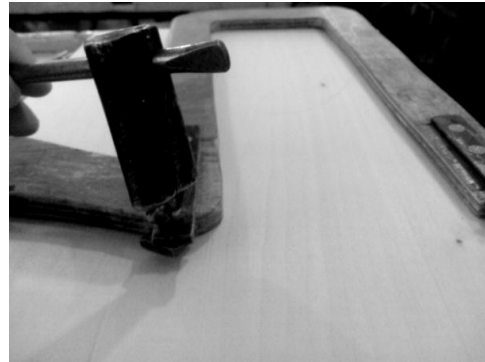
Рис. 7. Ключ для відкручування гайки-баранця
