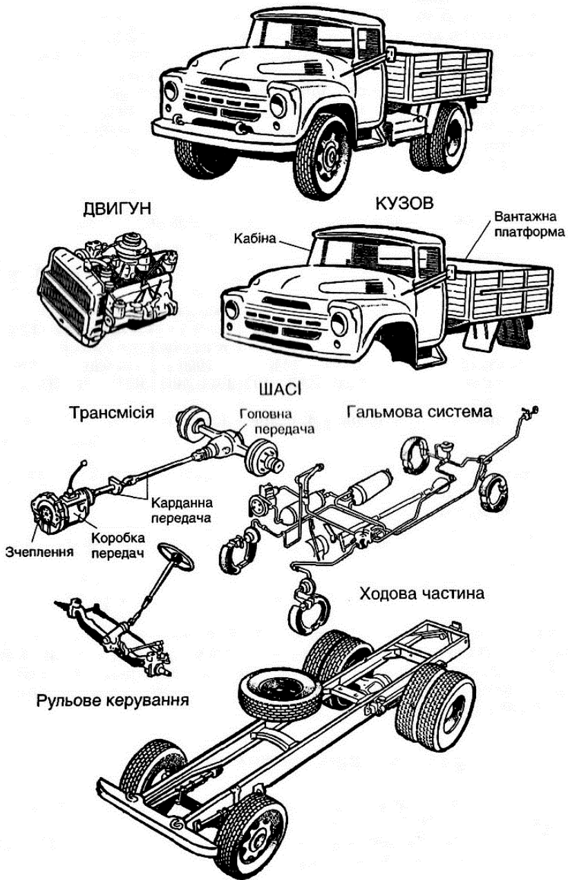
Рис. 1.1. Основні частини вантажного автомобіля
