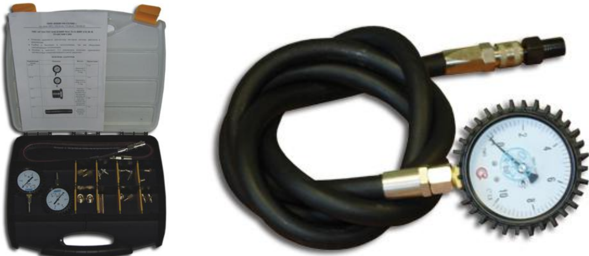
Рис. 5.5. Тестер тиску масла в двигуні та трансмісії SMC-107; Тестер тиску масла в двигуні SMC-106 mini.
