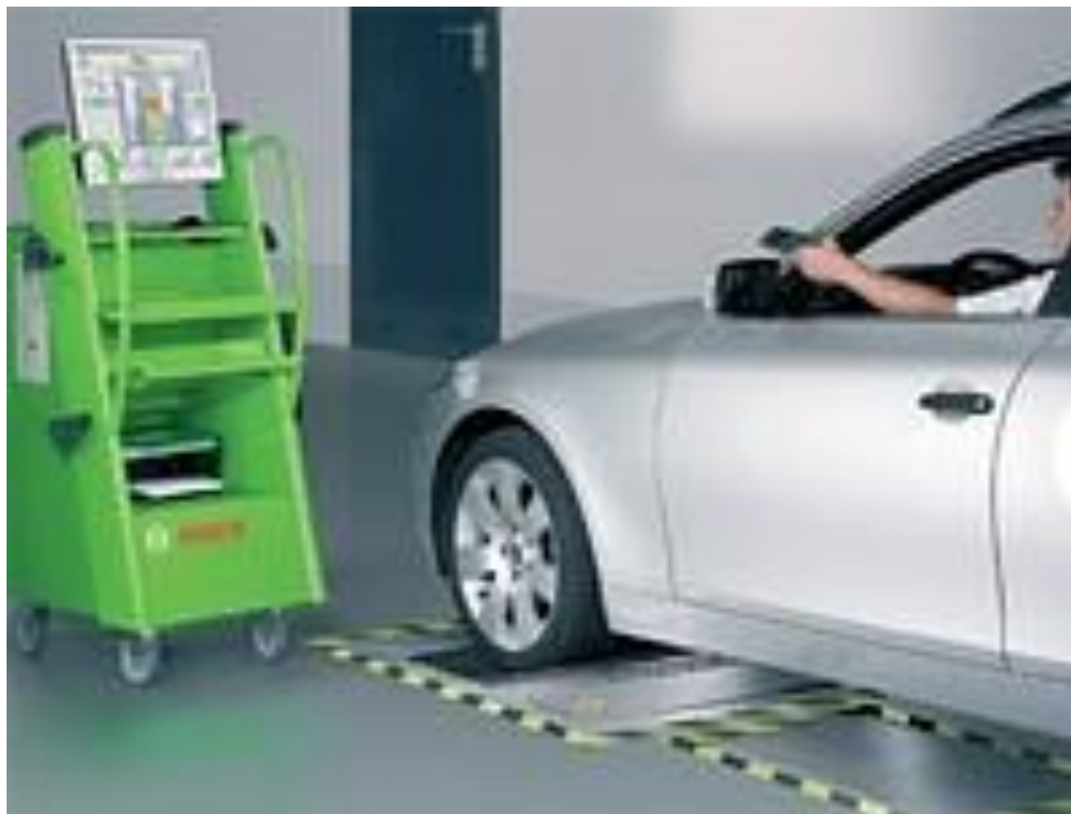
Рис. 13.2. Роликові гальмівні стенди МАНА LPS 3000; BSA 4310 (BOSCH)
