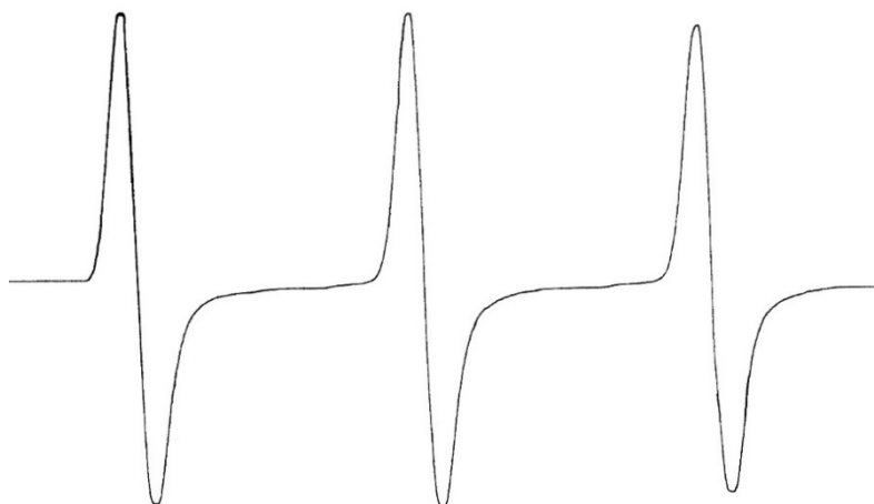
Рис. 3.8. Спектр ЕПР ТЕМРО у розчині ліпосом при T=298K та pH=7,4 .
