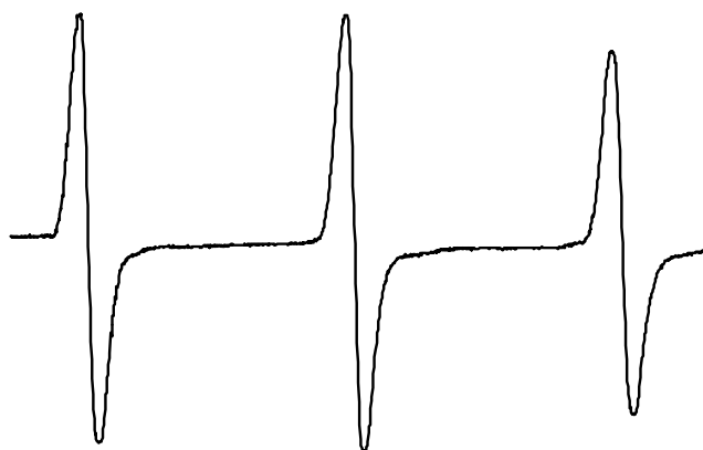
Рис. 3.7. Спектр ЕПР досліджуваних нітросильних радикалів ( ТЕМРО та адамантільний радикал) у розчині H_2O:EtOH (10%) при T=298K .
