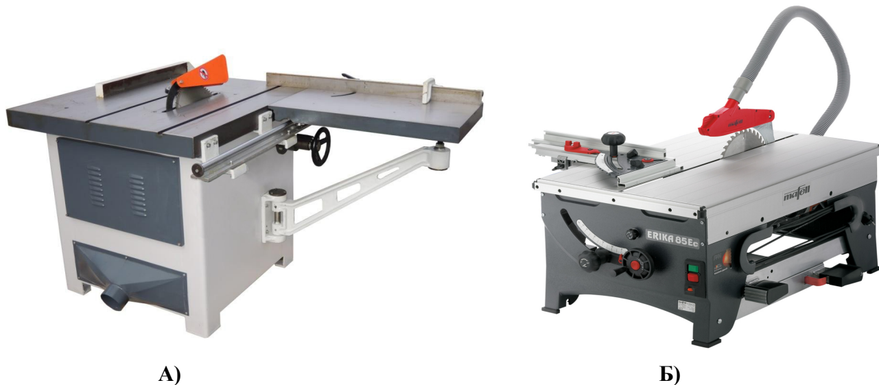
Рис. 2. Круглопильні верстати А) з торцювальною кареткою; Б) з протяжкою.
