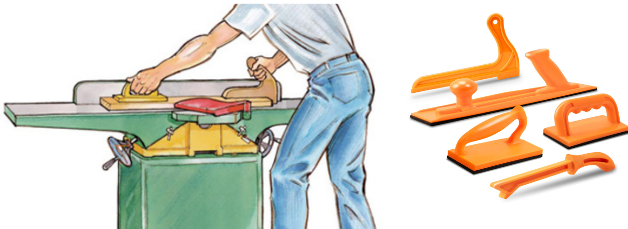
Рис. 11. Робота на фугувальному верстаті з використанням штовхачів та притискачів
