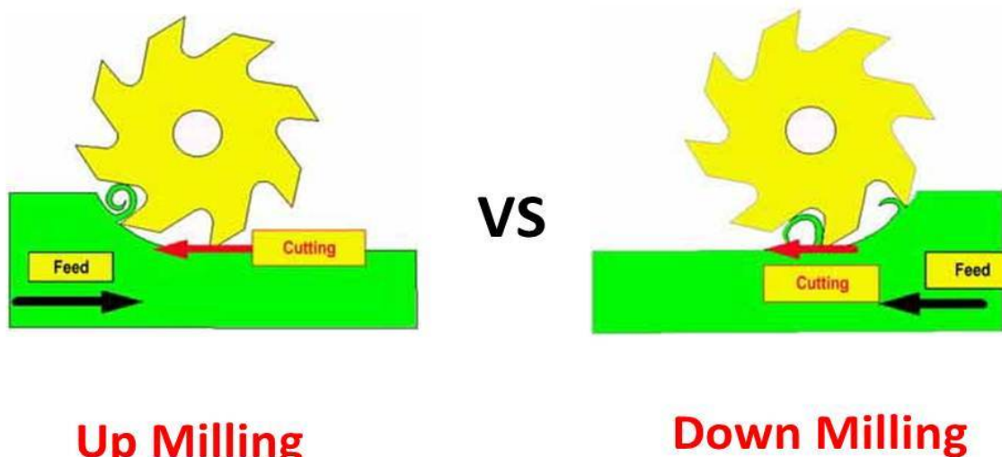
Рис. 7. Зустрічна та супутня обробка
