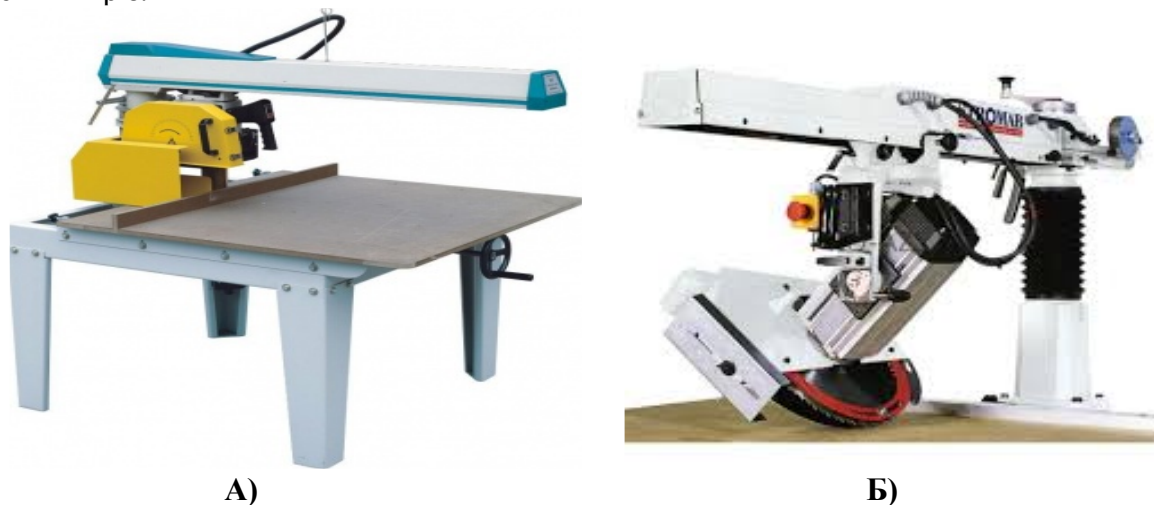
Рис. 7. Консольні верстати. А) звичайний консольний, Б) з поворотним механізмом.
