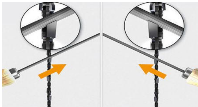
Рис. 9. Варіанти руху напилка: А – на ріжучу кромку; Б – від ріжучої кромки.
