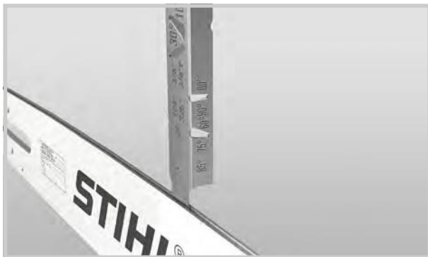
А) Б) Рис. 11. Прочистка пазу шини, виявлення глибини та стану зношення.
