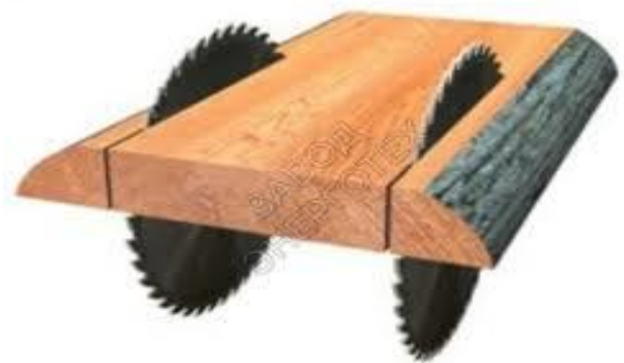
Рис. 1. Однопильний верстат (А) та схема роботи двохпильного верстата (Б).
