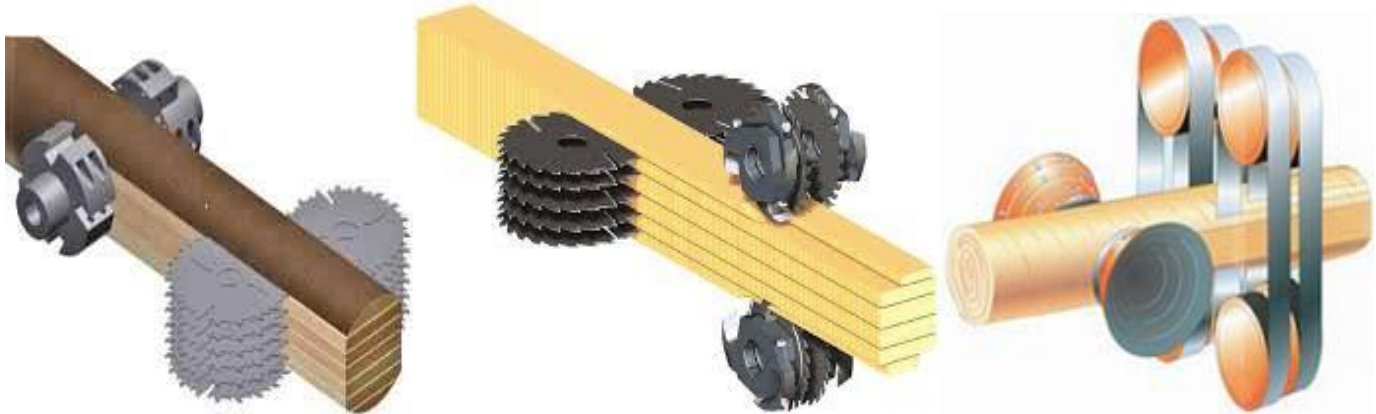
Рис. 10. Робота фрезеропильних та фрезернострічкових верстатів.
