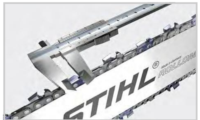
Рис. 6. Знаходження найкоротшого різця та його позначення.
