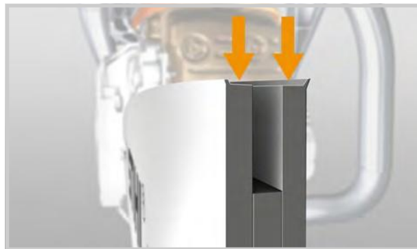
А) Б) Рис. 11. Прочистка пазу шини, виявлення глибини та стану зношення.
