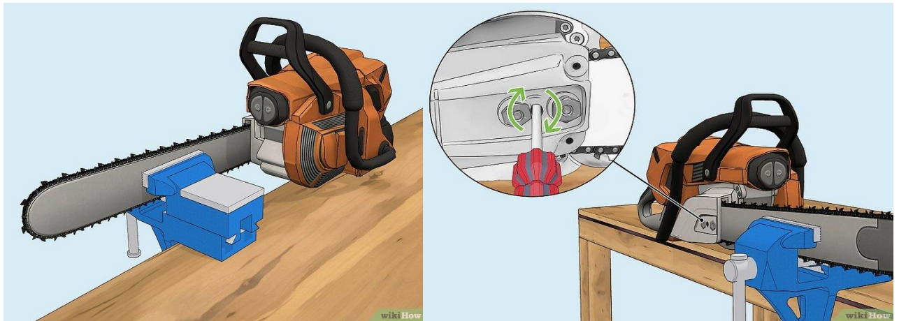
А) Б) Рис. 5. Фіксація пили в лещатах та натягування ланцюга.
