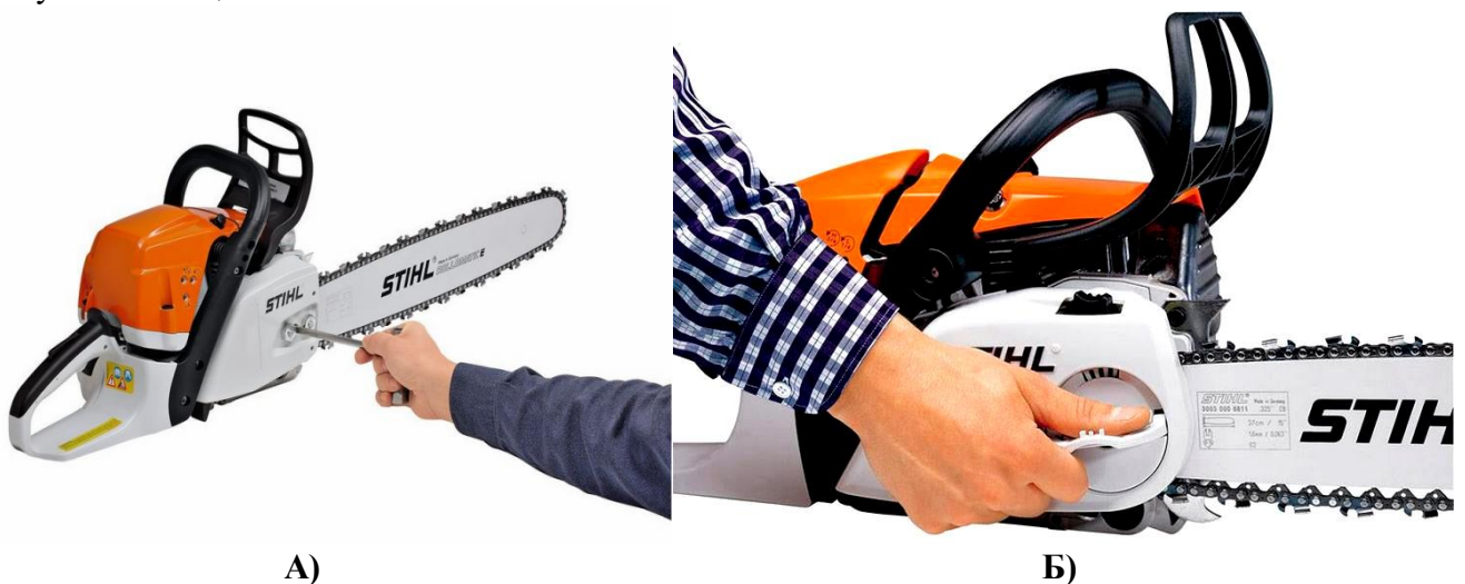
Рис. 3. Класична (А) та безключова (Б) система натягу ланцюга.
