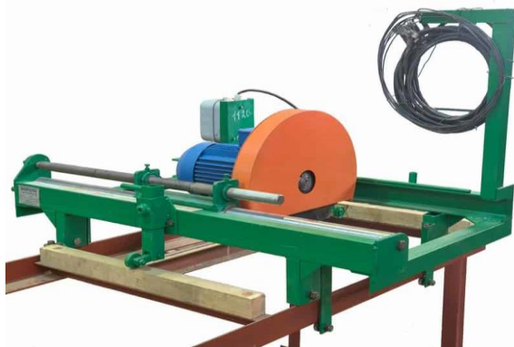
Рис. 2. Однопильний верстат з рухомим шпинделем (А) та двохпильний (Б).
