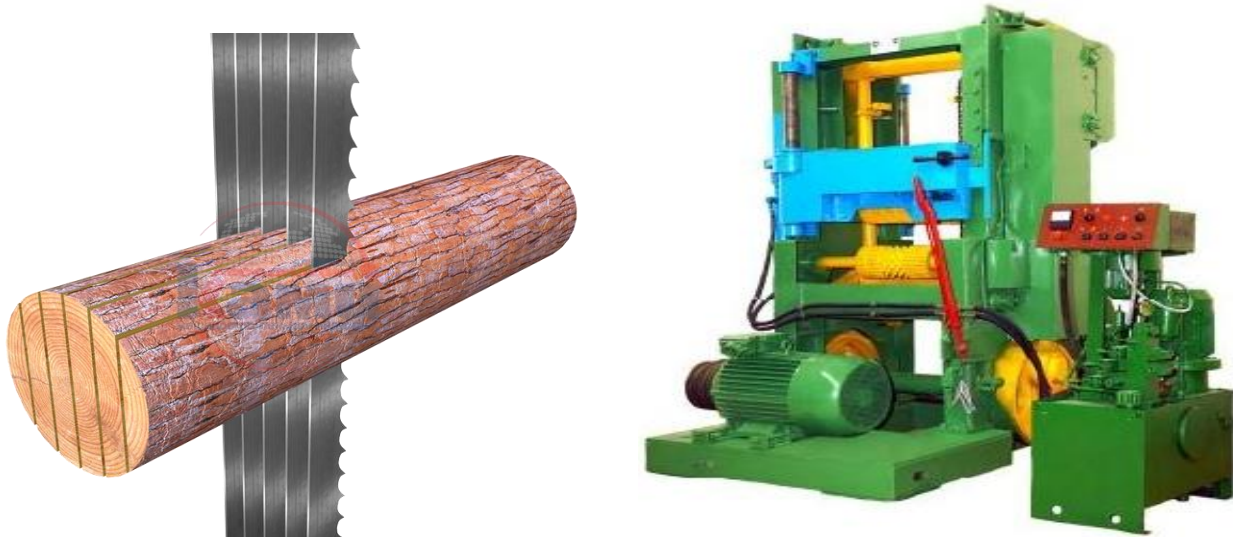
Рис. 1. Рамна пилорама, принцип роботи.
