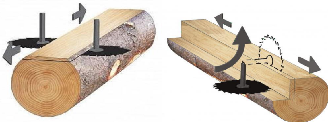
Рис. 1. Принцип роботи горизонтальних та кутоповоротних пилорам.
