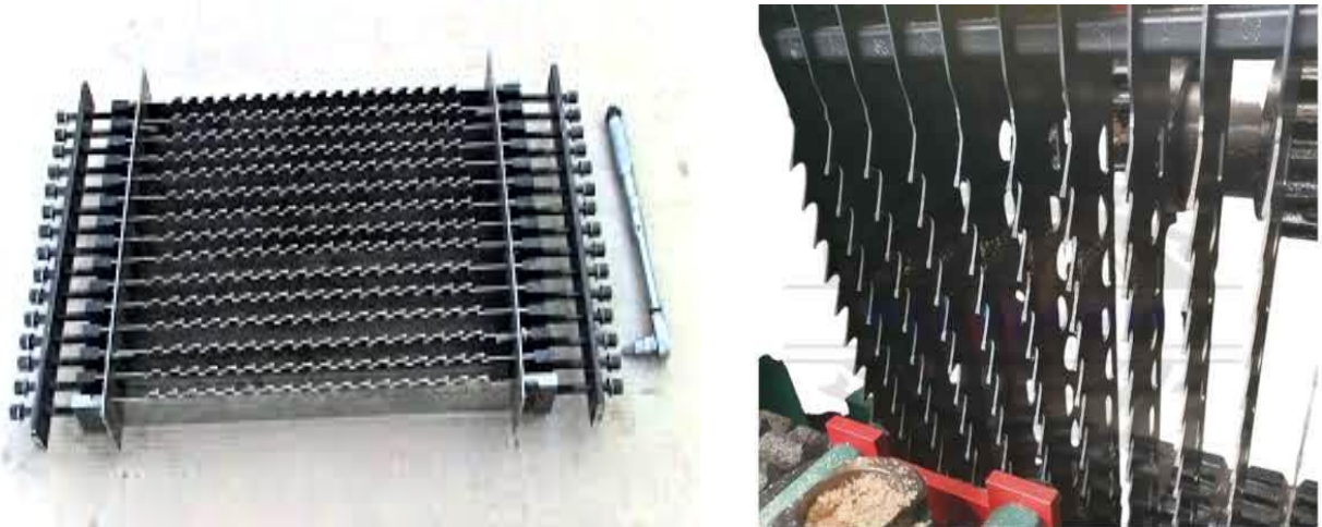
Рис. 2. Рамка та закріплені в ній пили.
