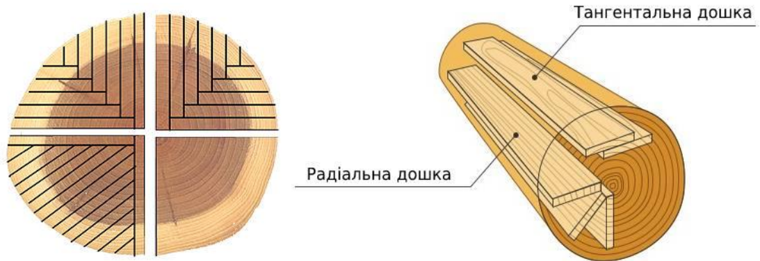
Рис. 3. Отримання радіального пиломатеріалу, способи ділення колоди.
