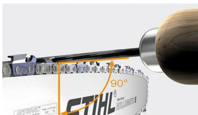
Рис. 8. Дотримання кутів при заточуванні ланцюга
