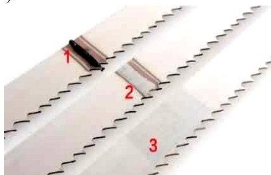
Рис. 1. З'єднання стрічкових полотен: 1. зварювання; 2. чорнова зачистка; 3. шліфування зварного шва.
