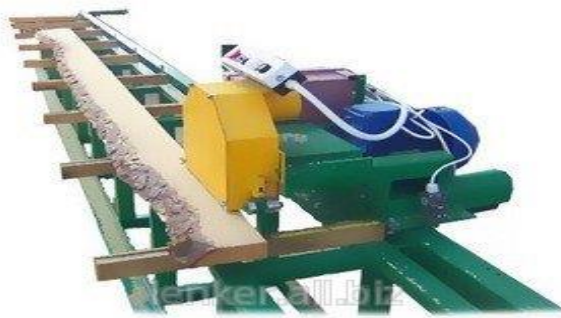
Рис. 1. Однопильний верстат (А) та схема роботи двохпильного верстата (Б).
