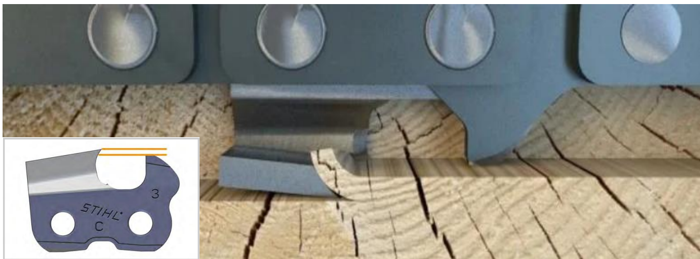
Рис. 5. Принцип роботи пильного ланцюга та обмежувача глибини різку.
