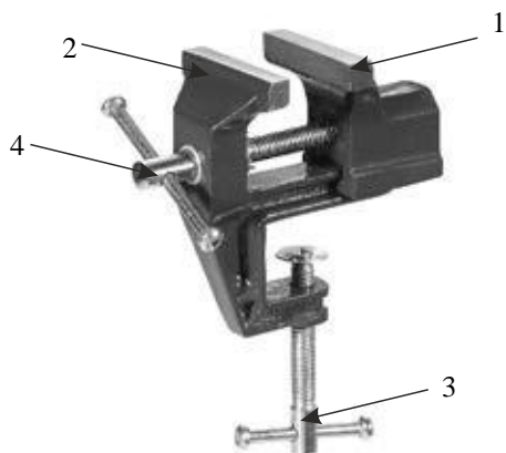
Мал. 2 Стільцеві лещата: 1 – рухома губка, 2 – нерухома губка, 3 – ніжка для закріплення, 4 – гвинт
