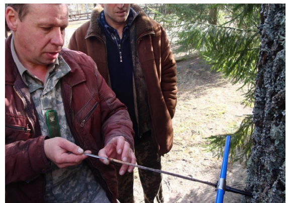
Рис. 5. Вікові бури Haglof, Mora та відбір приростного таксаційного керну
