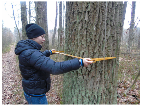
Рис. 1. Лісова мірна вилка Mantax Precision Blue та проведення вимірювання діаметра стовбура дерева на висоті 1,3 м.
