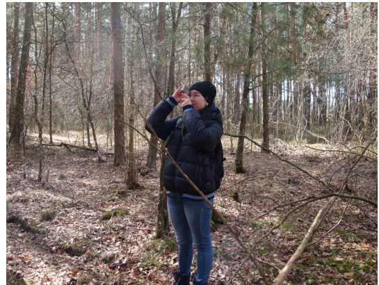
Рис. 4. Оптичний висотомір SUUNTO PM-5/1520 та проведення ним вимірювань висоти деревостану в лісових екосистемах
