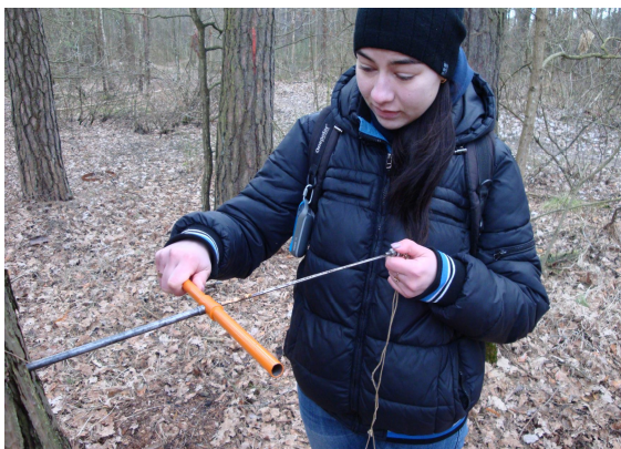
Рис. 5. Вікові бури Haglof, Mora та відбір приростного таксаційного керну
