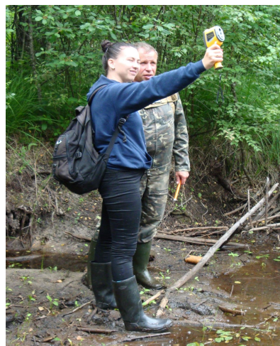
Рис. 3. Ультразвуковий висотомір Vertex III/M та його застосування
