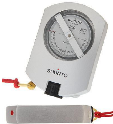
Рис. 4. Оптичний висотомір SUUNTO PM-5/1520 та проведення ним вимірювань висоти деревостану в лісових екосистемах
