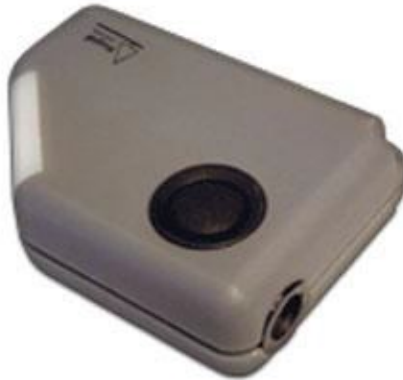
Рис. 2. Електронний висотомір Haglof Electronic Clinometer
