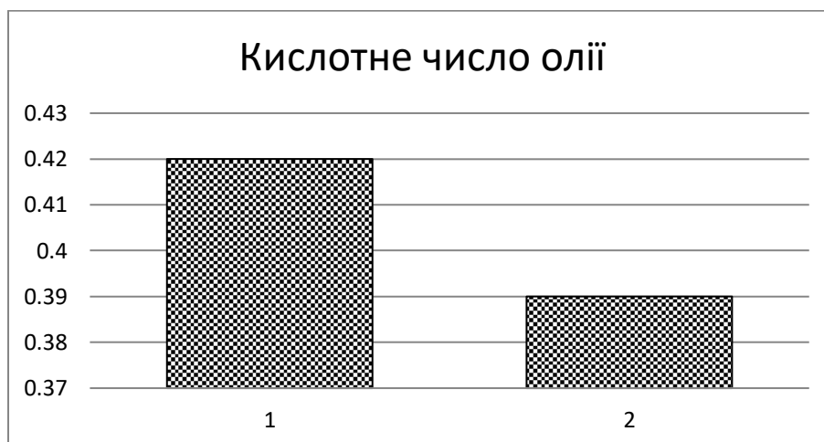
Рис. 3.1. Визначення вмісту кислотного числа в рафінованій олії
