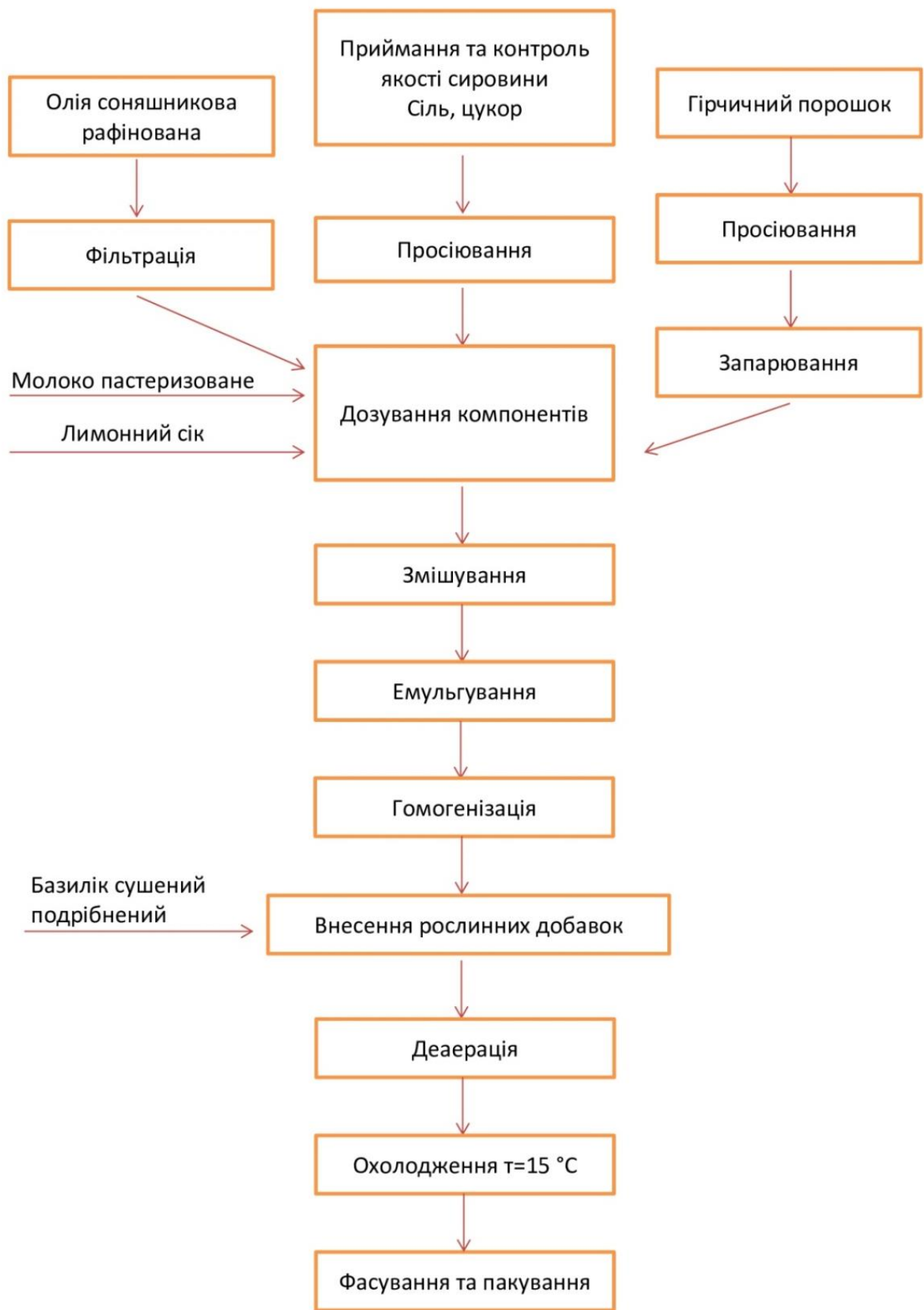
Рис. 3.10. Технологічна схема виробництва майонезу
