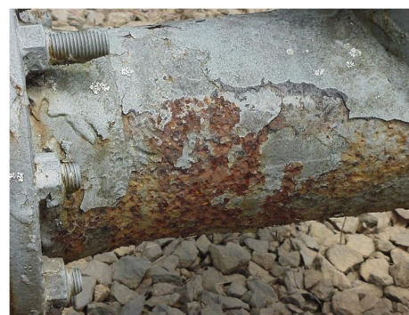
Рис. 1.2. Атмосферна корозія: а) механізм протікання; б) зовнішній вигляд.
