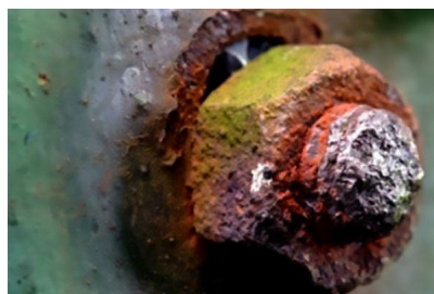
Рис. 1.6. Зовнішній вигляд мікробіологічної корозії
