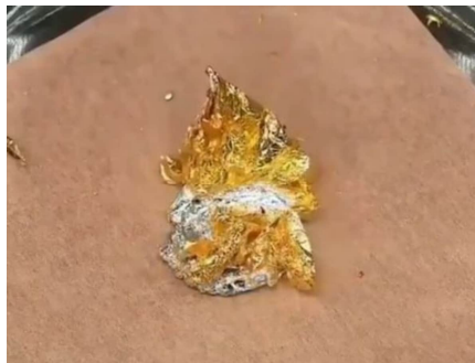
Рис. 1.5. Поглинання ртуттю золотої фольги як приклад рідкометалічної корозії
