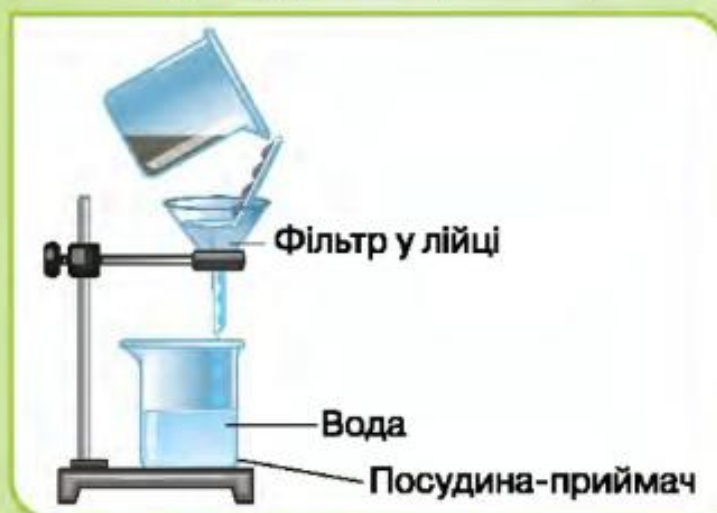
Мал. 30. Розділення сумішей фільтруванням
