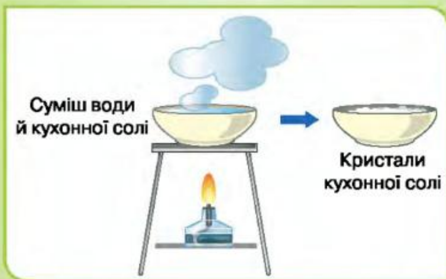
Мал. 31. Розділення суміші випарюванням
