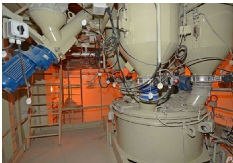
Рис. 3.1. Устаткування для цементування радіоактивних відходів на Рівненській АЕС
