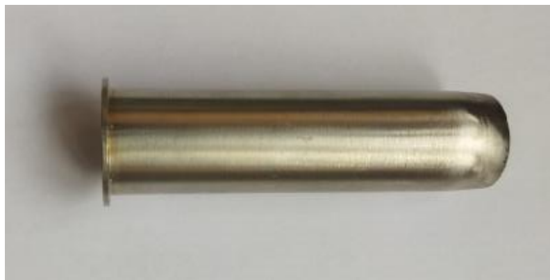
Рис. 3.1. Металевий циліндр внутрішнім діаметром 30 мм, з загостреним кінцем з однієї сторони
