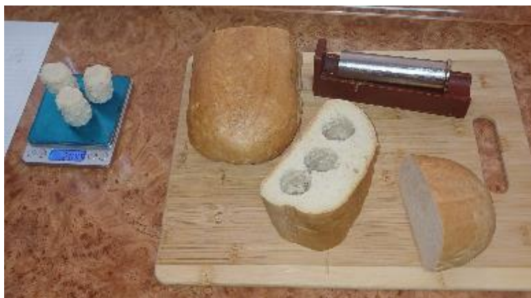
Рис. 4.1. Елемент процедури відбирання та зважування зразків хліба за методикою ДСТУ 7045:2009
