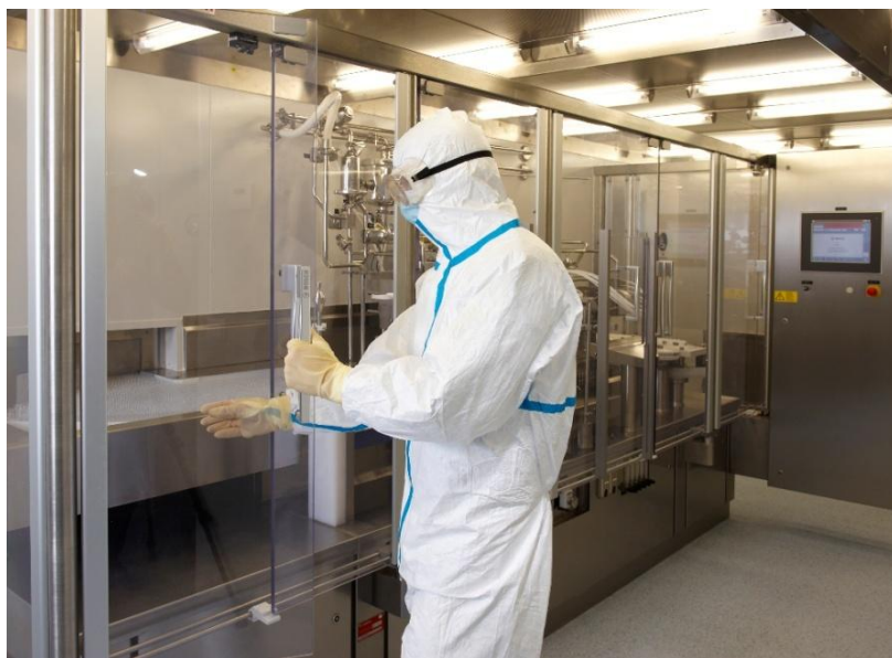
Рис. 2.4. Маніпуляції виробничого персоналу в асептичному ядрі під час наповнення ін'єкційних препаратів
