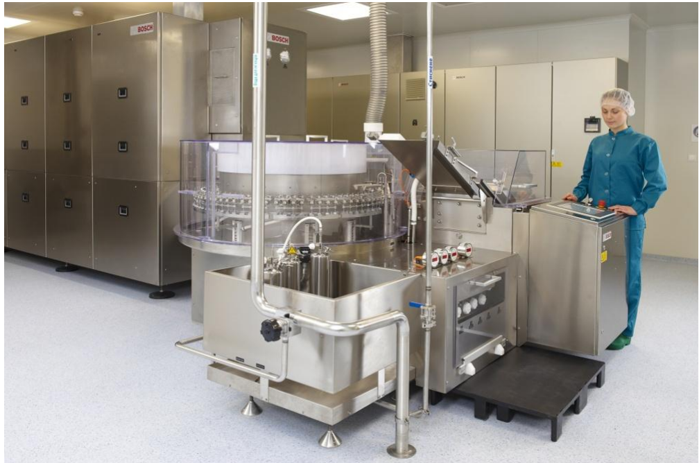
Рис. 2.3. Підготовка ампул до асептичного наповнення ін'єкційних препаратів
