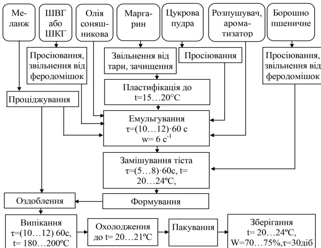
Рисунок 2.5 – Технологічна схема виробництва здобного печива з додаванням шроту волоських горіхів [9]
